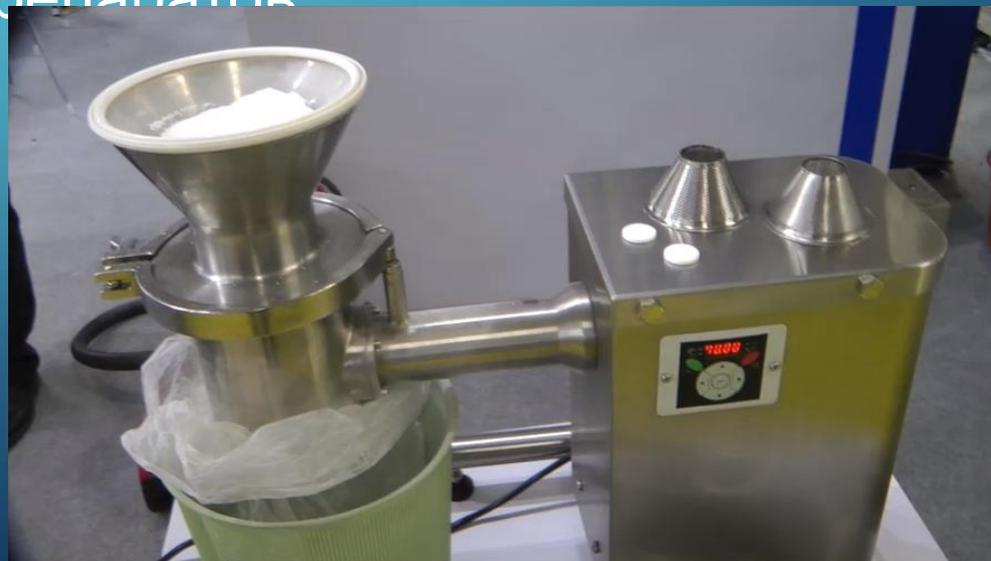
Оборудование при фармацевтическом производстве применяется в зависимости от выбранного метода изготовления таблеток.
