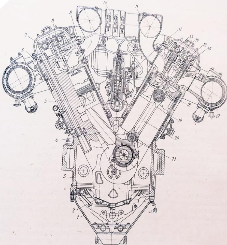
1-поддон; 2-коренной подшипник; 3-несуший картер; 4- главный шатун; 5-анкерные шпильки; 6-блок цилиндров; 7-колпак моноблока; 8-форсунка; 9-пусковой клапан; 10-топливный фильтр; 11-надувочный коллектор; 12-ТНВД; 13-распредвал впуска; 14-впускные клапана; 15-распредвал выпуска; 16-выпускные клапана; 17-выпускной коллектор; 18-укороченный поршень; 19-втулка цилиндра; 20-прицепной шатун; 21- палец прицепного шатуна
