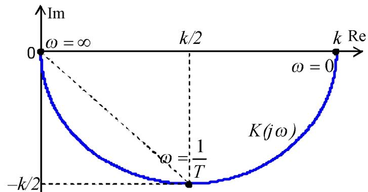
Очевидно, что с ростом частоты  $A(\omega)$  снижается, а  $\theta(\omega)$  возрастает. В действительности частотная характеристика  $K(j\omega)$  будет иметь форму полукруга.
