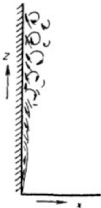
Рис. IX.15. Характер свободного движения воздуха около вертикальной нагретой поверхности
