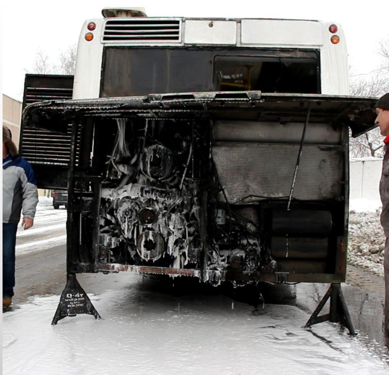
Вид моторного отсека автобуса ЛиАЗ – 5256 после срабатывания Системы АУЖПТ «ВОДОЛЕЙ-3Н»
