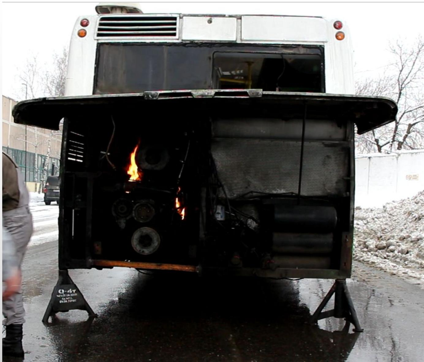
Вид пламенных очагов возгорания в моторном отсеке автобуса ЛиАЗ – 5256
