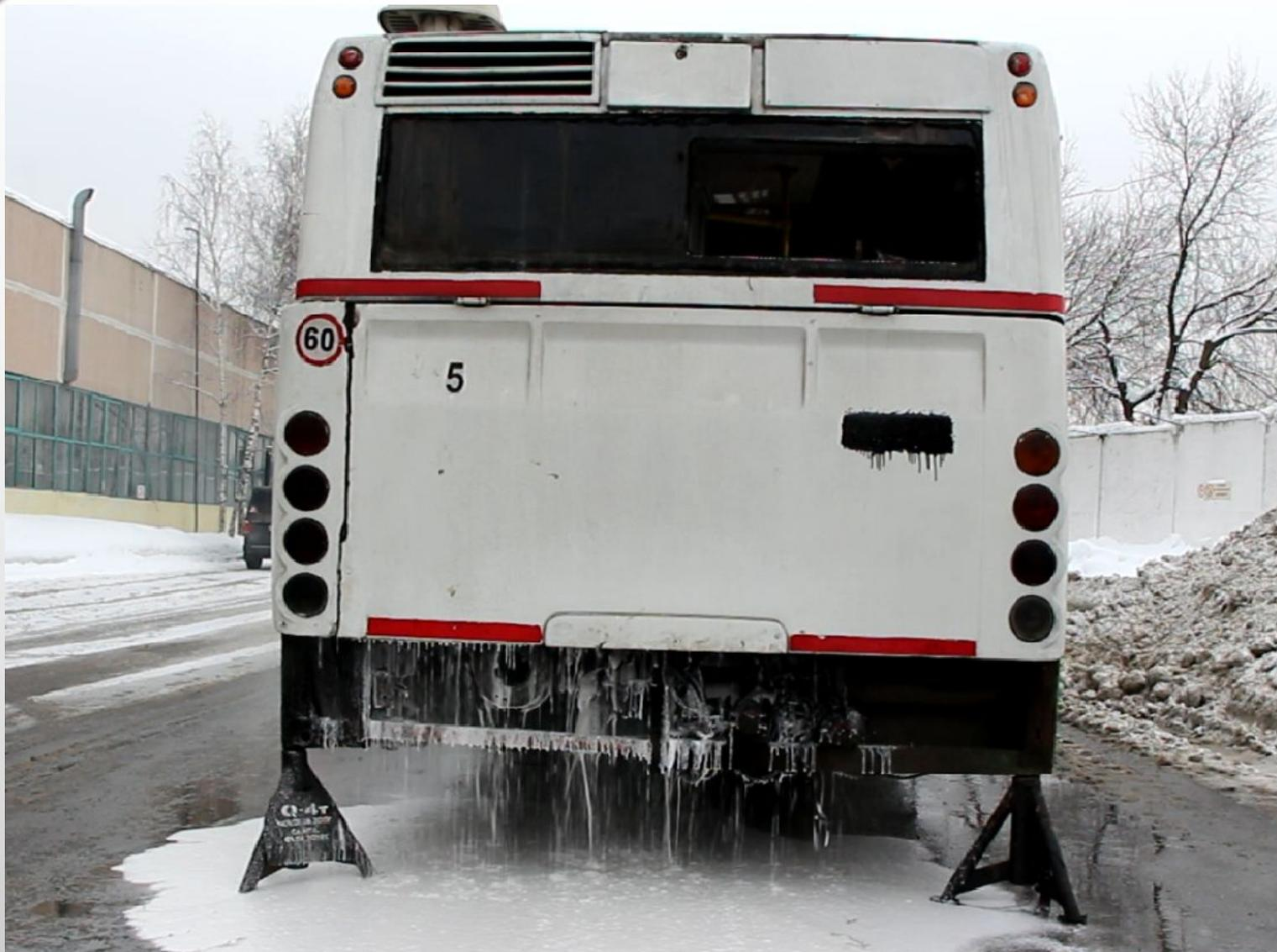
Вид моторного отсека автобуса ЛиАЗ – 5256 при срабатывании системы АУЖПТ «ВОДОЛЕЙ-3Н»
