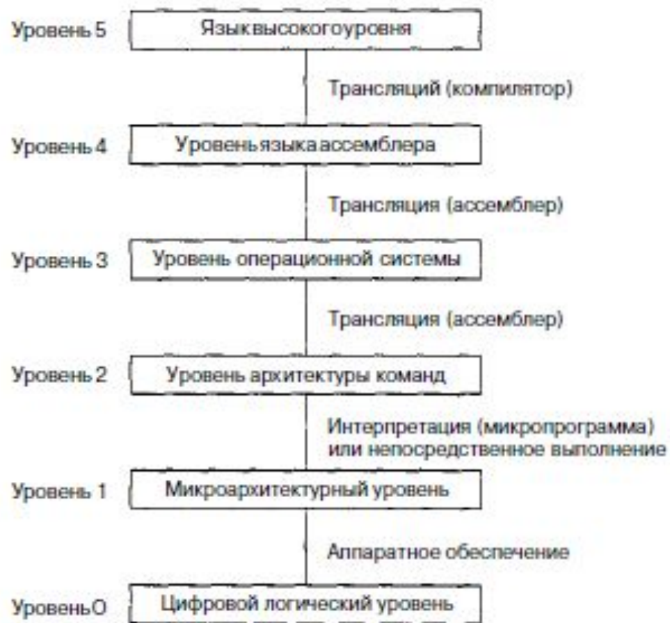
Рис. 1.2. Компьютер с шестью уровнями. Способ поддержки каждого уровня указан под ним. В скобках указывается название поддерживающей программы
