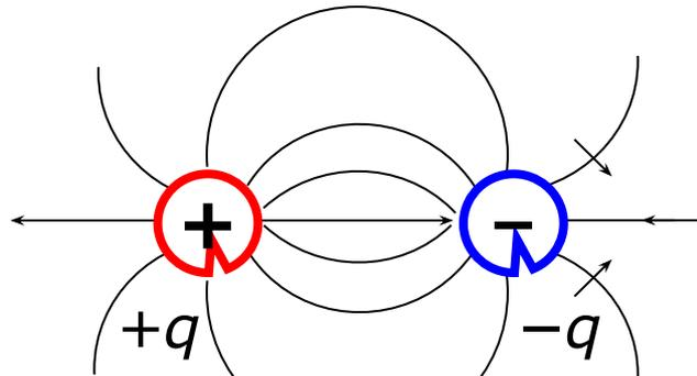
*Определение:* Электрический диполь – система из двух одинаковых по величине разноименных точечных зарядов ( $+q$ ,  $-q$ ), находящихся друг от друга на достаточно малом расстоянии  $l$ .
