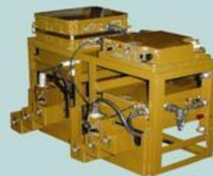
Новым типом технических средств постановки аэрозольных завес является радиоэлектронное средство управления внешними устройствами РПЗ-8Х, с помощью которого можно применять все средства аэрозольного противодействия, приводящиеся в действие с помощью электрических импульсов (шашки типа УДШ, ШД-П, БДШ-5, аэрозольный генератор универсальный АГУ).
