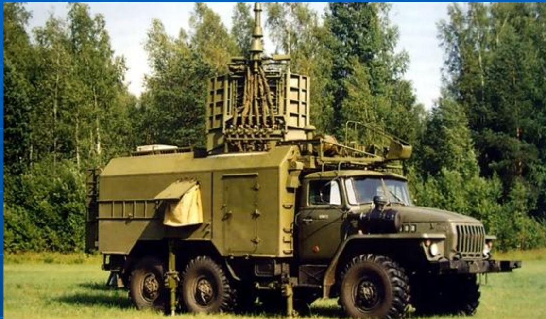
Используется в составе мобильного комплекса радиоэлектронного подавления и предназначен для разведки импульсных самолетных РЛС бокового обзора (БО), РЛС управления оружием (УО) класса "воздух - земля", РЛС обеспечения полетов на малых высотах (ОПМВ) и передачи на автоматизированный ротный командный пункт управления АПУР следующей информации:
