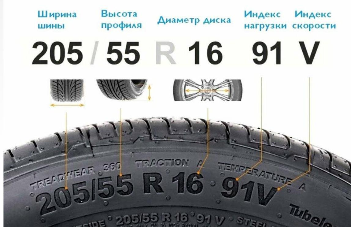
Шина с обозначением размеров 165/70 SR13 имеет обозначение: ширины В профиля шины – 165мм, посадочного диаметра d-13 дюймов; 70-процентное отношение высоты Н профиля шины к ширине В; R – радиальная S – буква индекса максимальной скорости - букве S соответствует максимальная скорость движения автомобиля 180 км/ч.
