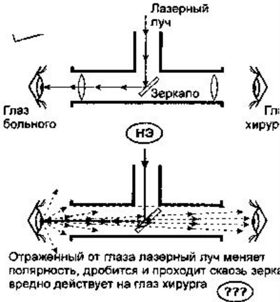
Система: лазерный луч, зеркало, глаз больного, глаз хирурга. Полупрозрачное зеркало направляет луч лазера в глаз больного, и позволяет хирургу следить за ходом операции.
