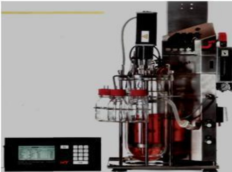
Рис.47. Универсальный лабораторный биореактор:
