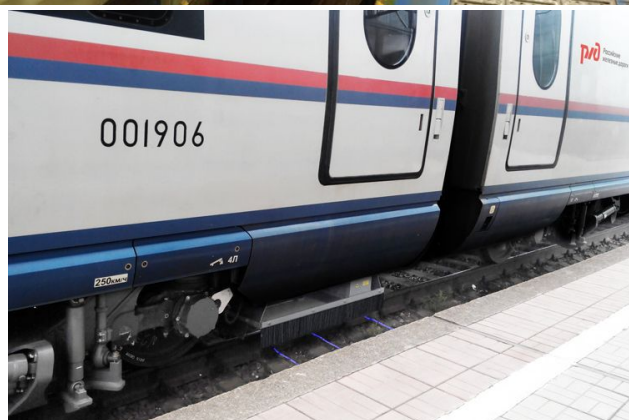
Информационно-измерительная система «ИНФОТРАНС-ВЕЛАРО Rus», установленная на электропоезде «Сапсан»
