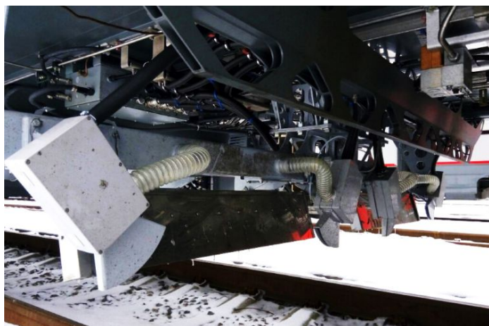
Информационно-измерительная система «ИНФОТРАНС-Ласточка», установленная на электропоезде «Ласточка»
