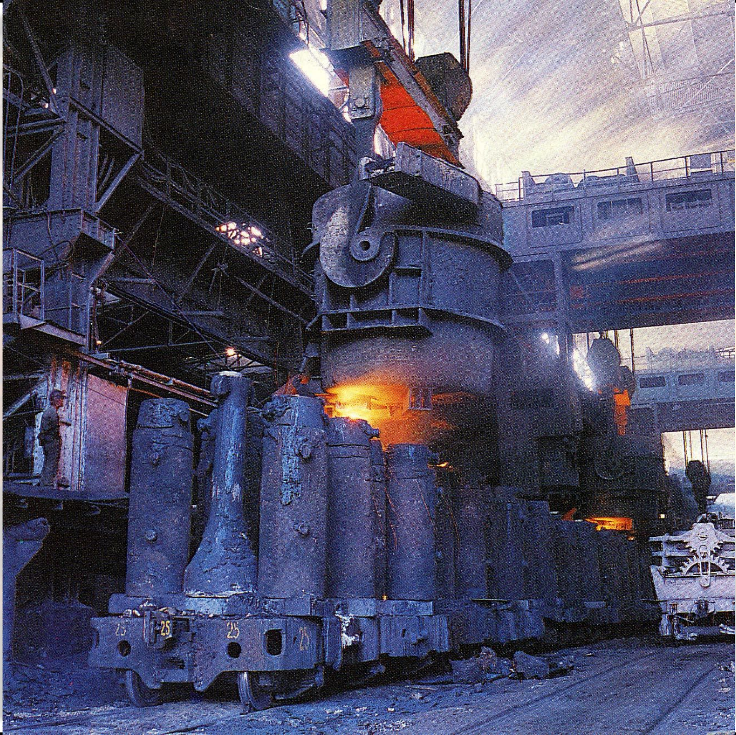
Сифонная разливка стали
