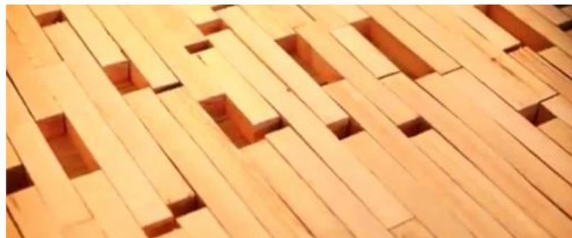
4. На специальной линии сращивания осуществляется склеивание бездефектных заготовок по длине в мебельный щит. Прочность дверного полотна обеспечивается за счет клеевого шипового соединения отдельных заготовок. Склеенные брусья обрабатываются с четырех сторон на фрезерных станках до требуемого сечения.
