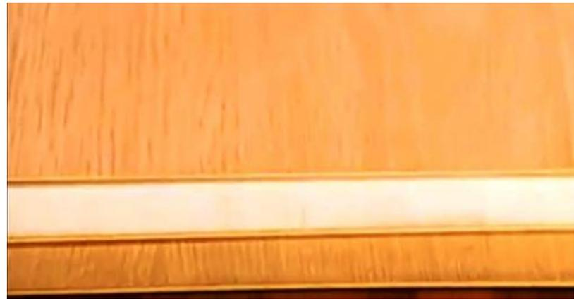
11. Шпонированную фанеру наносят на склеенное из ламелей дверное полотно, и помещают под холодный пресс на 30-40 минут, пока сохнет клей. Дальше – все составляющие конструкции двери шлифуются и проверяются на соответствие, чтобы в дальнейшей сборке исключить наличие недопустимых зазоров или перепадов.
