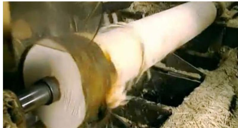
8. Следующий этап – *круговая обрезка*. Бревно постоянно вращается, а станок снимает с него тонкий слой шпона, толщиной всего в 0,6 см. Со среднего бревна получается около 134 линейных метра шпона.
