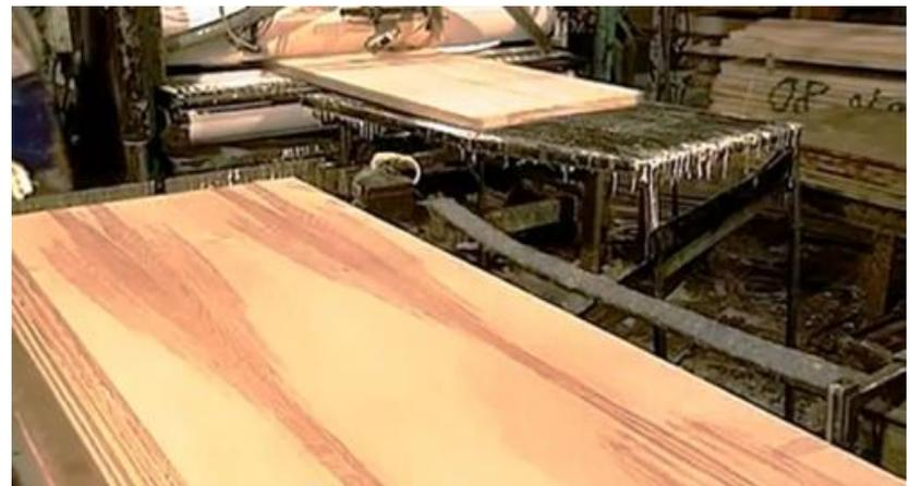
12. Следом происходит замер длины/ширины изделия. Дверь отправляется на станок, который снимает фаску и обрезает края по заданным размерам. На следующем станке – выдалбливаются пазы для петель.
