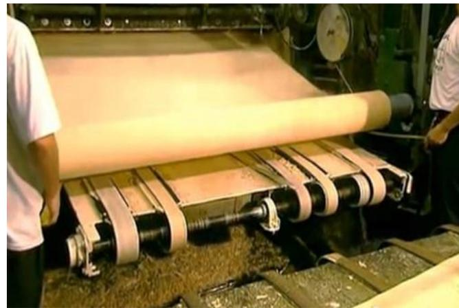
9. Затем шпон разворачивается и разрезается на листы. Листы с одинаковым узором волокон укладываются в стопку. Из них отбираются впоследствии части для внешней облицовки двери.
