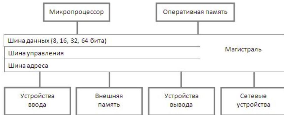
К магистральной подключаются процессор и оперативная память, а также периферийные устройства ввода, вывода и устройства хранения информации, которые обмениваются информацией на машинном языке (последовательностями нулей и единиц в форме электрических импульсов).
