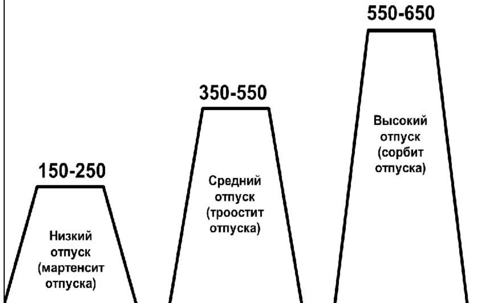
Рис. 33.1. Разновидности отпуска стали и получаемые структуры
