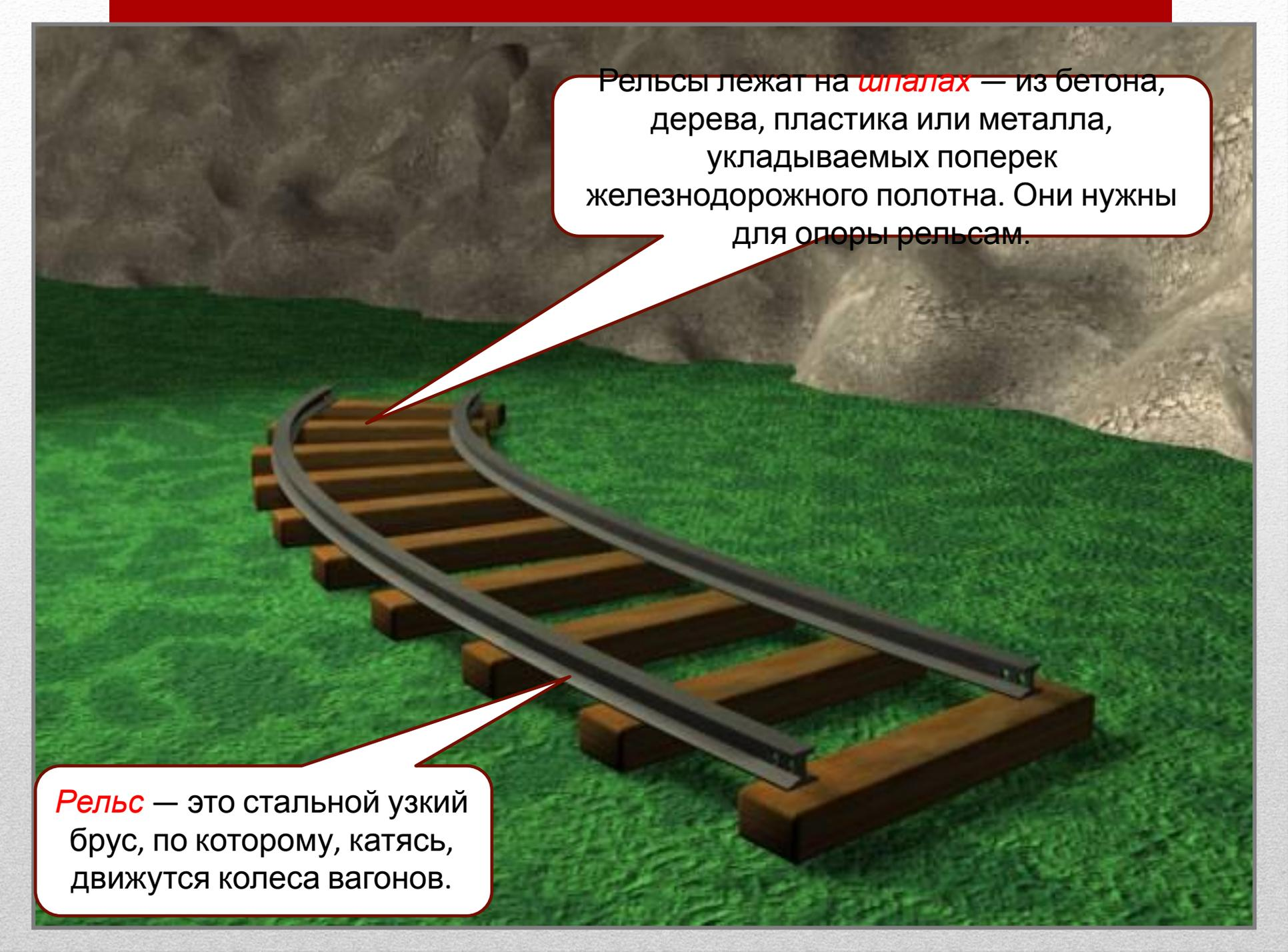
Рельсы лежат на *шпалах* — из бетона, дерева, пластика или металла, укладываемых поперек железнодорожного полотна. Они нужны для опоры рельсам.
