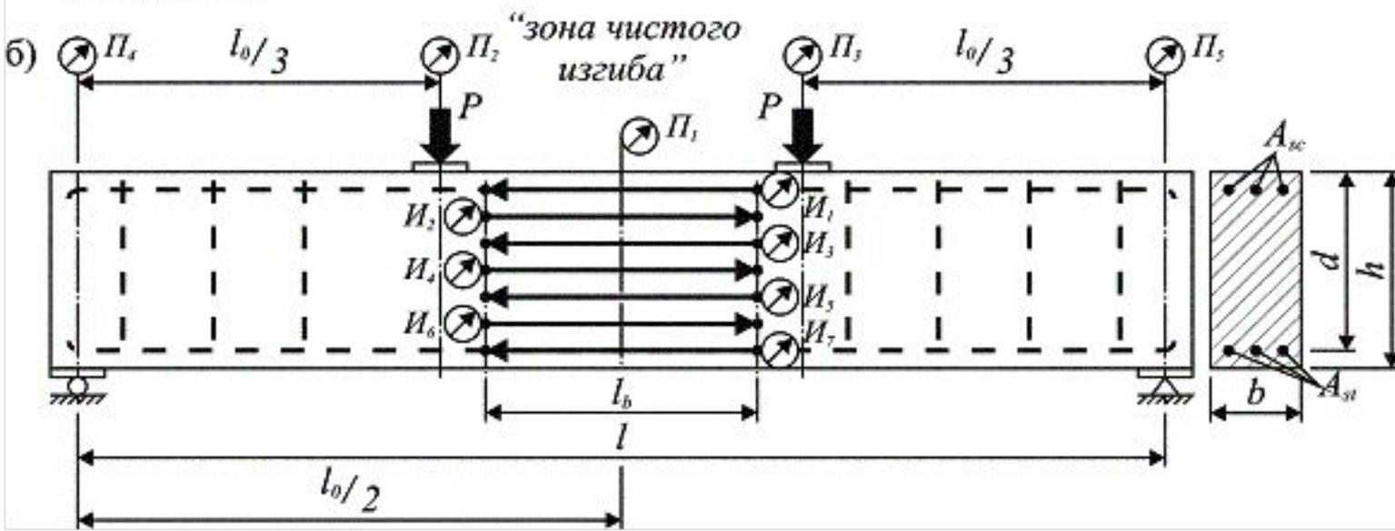
Последовательное нагружение элемента позволило выявить ряд стадий напряженно-деформированного состояния в нормальном сечении.
