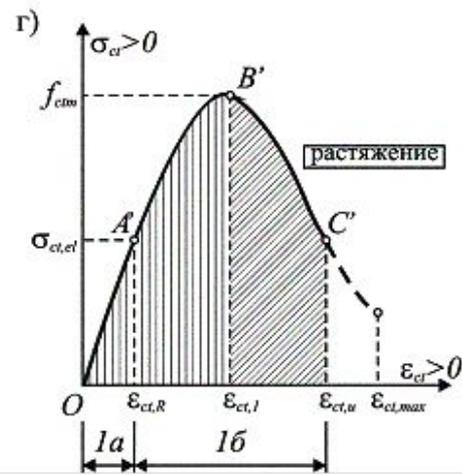
Таким образом характерными чертами стадии 1 напряженно-деформированного состояния сечения являются:
