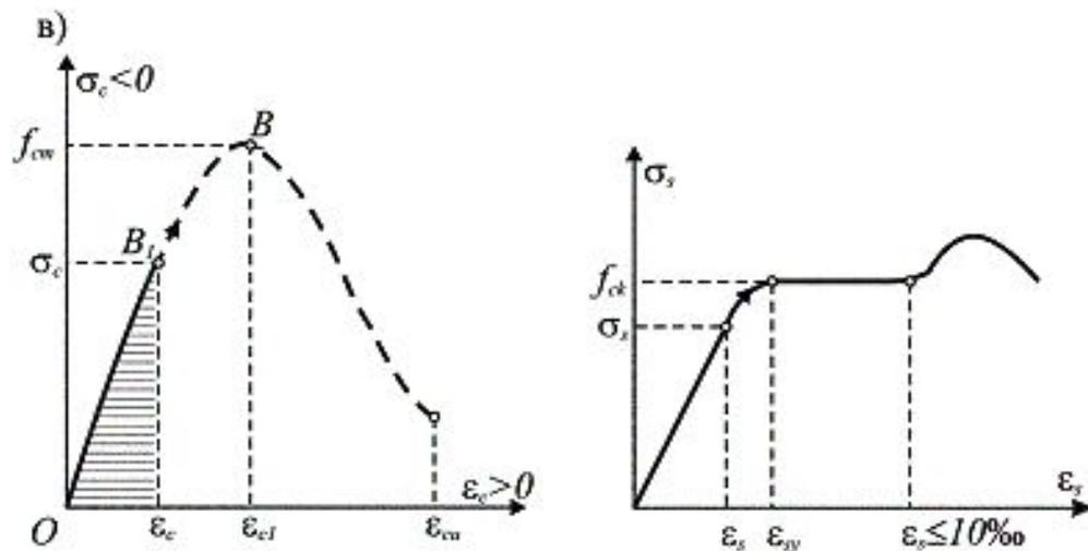
Стадия 2 характеризует сопротивление конструкции при эксплуатационном нагружении и используется при расчете конструкций по раскрытию трещин и прогибам.
