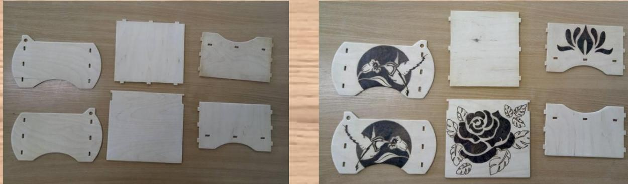
Для скрепления фанерных деталей применяется шиповое фанерное соединение: шип-гнездо. Шипы и гнёзда располагаются на определённом расстоянии друг от друга. Крышка шкатулки открывается с помощью отверстий, просверленных сверлом Ø 8 мм. на ушках боковых стенок. Изделие имеет оригинальный эстетический вид.
