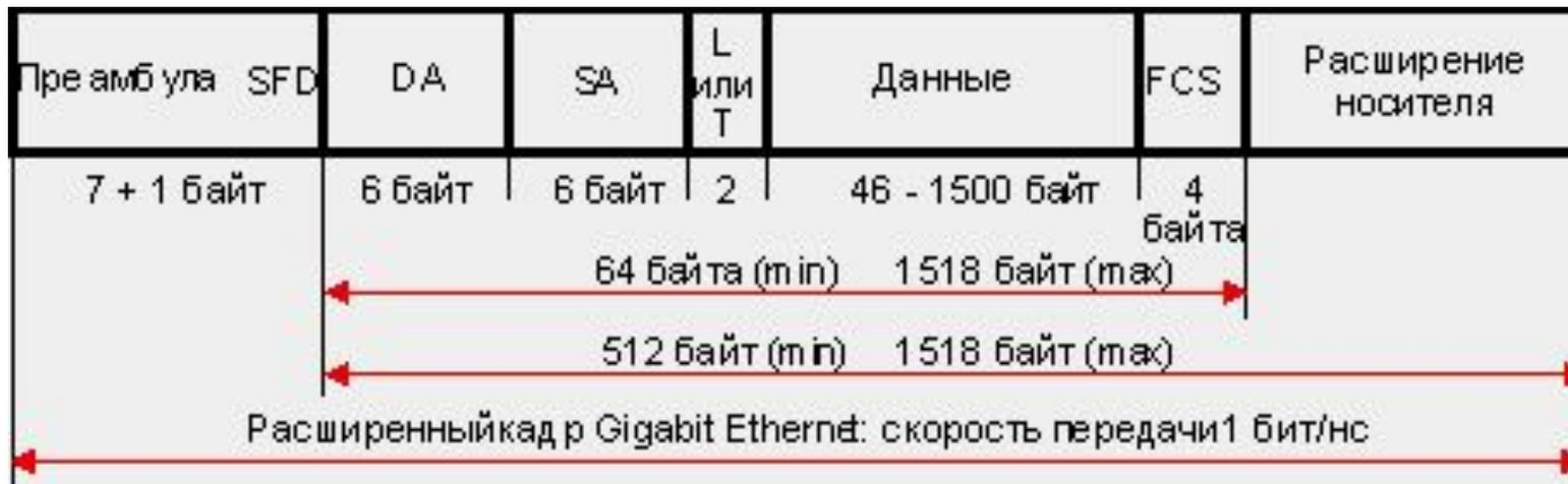
Рисунок 5. Кадр Gigabit Ethernet с полем расширения носителя
