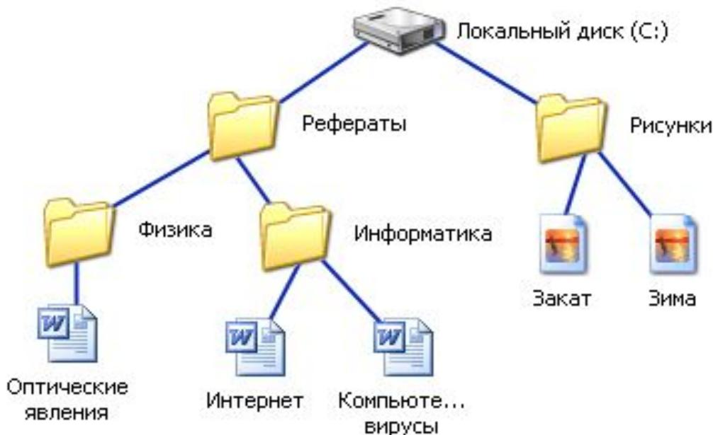
Для того чтобы найти файл в иерархической файловой структуре необходимо указать путь к файлу. В путь к файлу входят записываемые через разделитель "\" логическое имя диска и последовательность имен вложенных друг в друга каталогов, в последнем из которых находится данный нужный файл.
