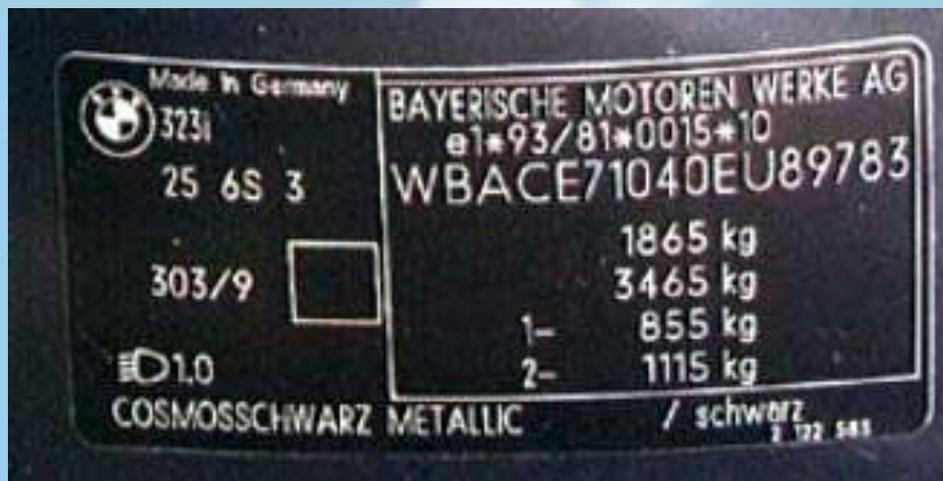
Наклейка изготовлена из **фольги на акриловой основе**, имеет черное покрытие на которую лазером наносятся данные. Фольга изготовлена таким образом, что при краже и попытке замены она быстро ломается.
