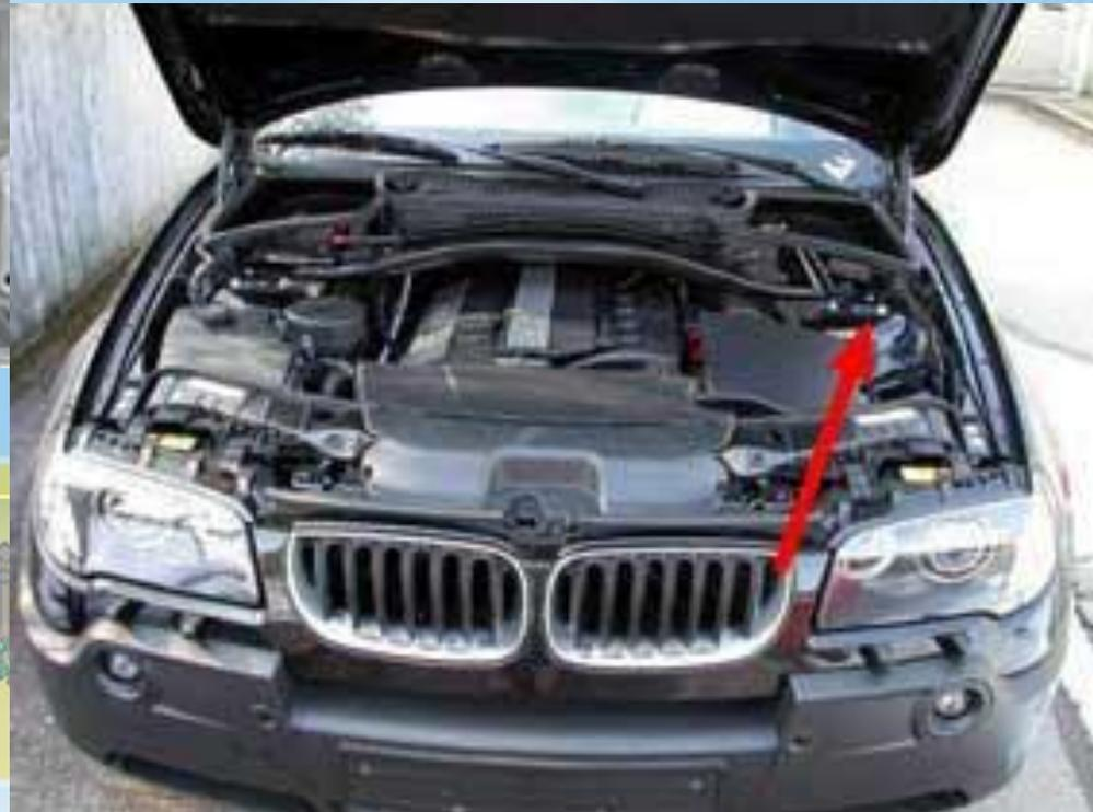
Вид номера кузова на серии E 83 (X 3)
