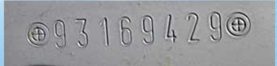
Исключение: Номер кузова на Z4 и X5 Z 4 – только номер без каких либо знаков в начале или конце Номер кузова Мини
