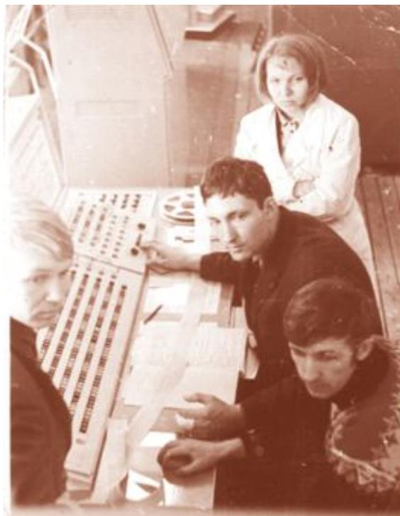
В ЭВМ первого поколения (1950-е годы) управление вычислениями велось с пульта управления. Каждая программа вручную вводилась с перфокарт и запускалась оператором. Это приводило к простоям дорогостоящего оборудования и ошибкам
