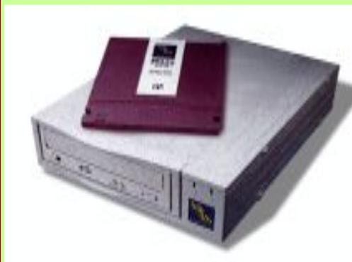
Супер-флоппи диск - накопитель "ZIP" со сменными магнитными дисками 3,5" емкостью 100 Мбайт существенно увеличивает дисковое пространство жесткого диска. Применяя стандартные методы архивации можно на одном таком диске записать до 200 Мб информации. Дисковод для накопителя "ZIP" легок и компактен (450г), заключен в прочный пластиковый корпус и не боится ударов.. Быстродействие выше, чем у дискет.
