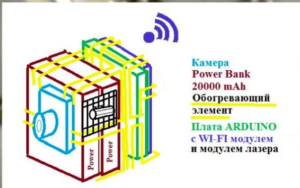
Схема 2. Тривиальная схема опытной модели - Инфоблок.
