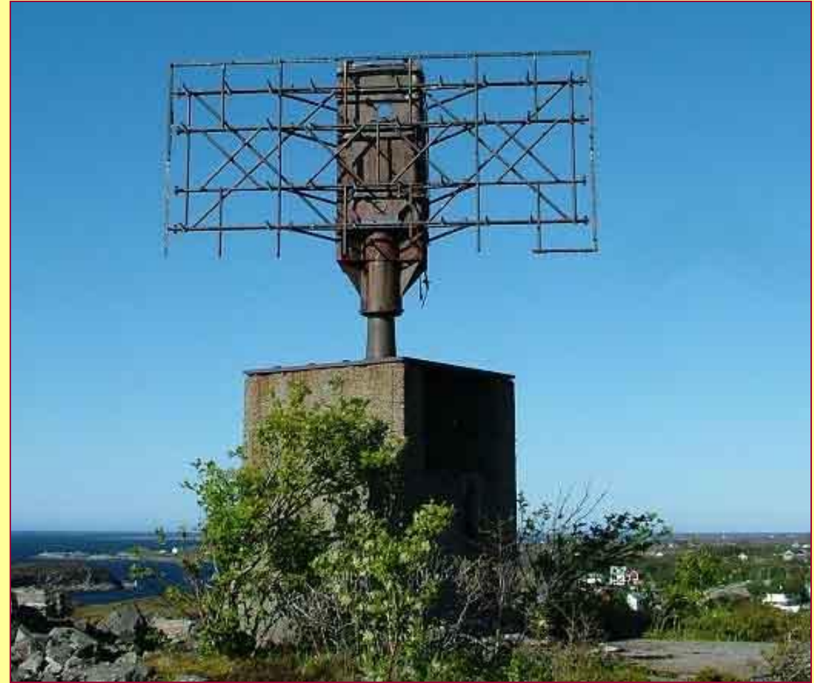
РЛС Seetakt: Частота 368 - 390 МГц, длина волны 82 - 77 см. Длительность импульса 3 мкс, период повторения 2000 мкс.
