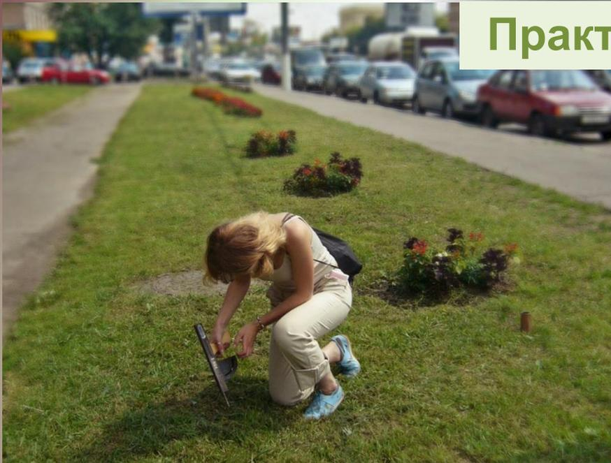
Определение плотности почвы
