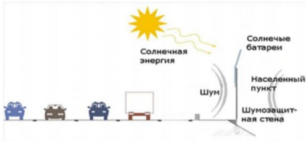
*Расположения шумозащитных экранов с фотоэлектрическими преобразователями (солнечными панелями) в пределах полосы отвода автомобильной дороги*
