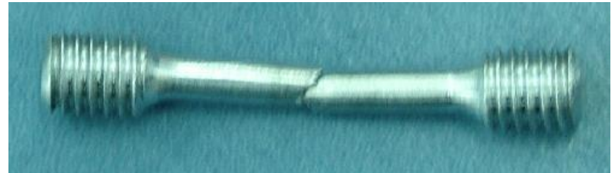
Цилиндрический образец после разрушения
