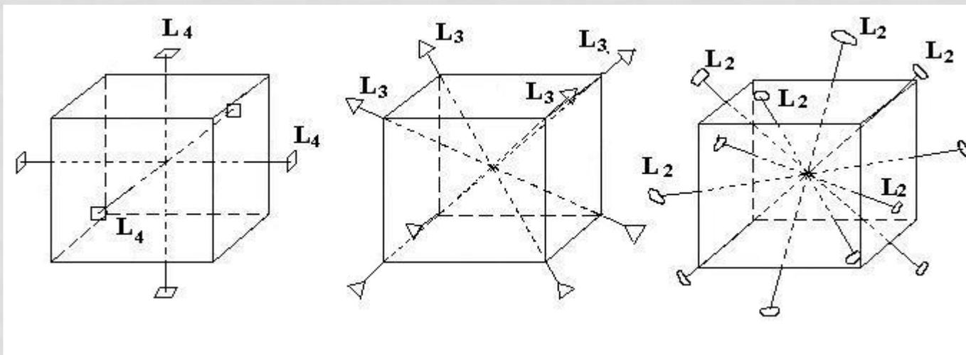
Рис.3.5. Оси симметрии в кубе
