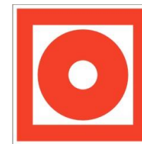
Кнопка включения установок (систем) пожарной автоматики
