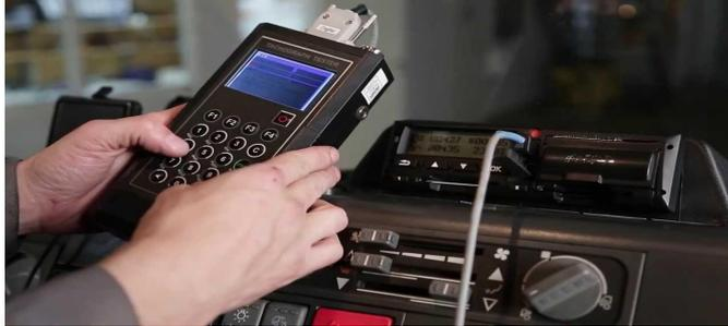
Тахограф - это специализированный прибор для измерения, позволяющий осуществлять контроль транспортного средства во время движения. А именно: сохранение информации о фактах нарушения установленного скоростного режима; отслеживание расстояния и маршрута пройденного пути; контроль над соблюдением водителем требований трудового законодательства, регламентирующего время труда и отдыха.
