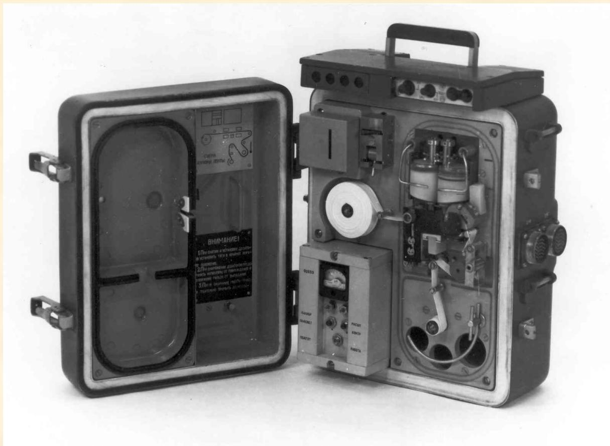
Автоматический газосигнализатор ГСА-12 предназначен для автоматического контроля окружающего воздуха с целью обнаружения в нем паров фосфорорганических токсичных химикатов (ФТХ).
