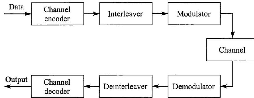
Перед подачей на модулятор можно перемешивать модуляционные символы так, чтобы рассеять / декоррелировать ошибки. В приёмнике перед декодированием нужно выполнять обратную процедуру.
