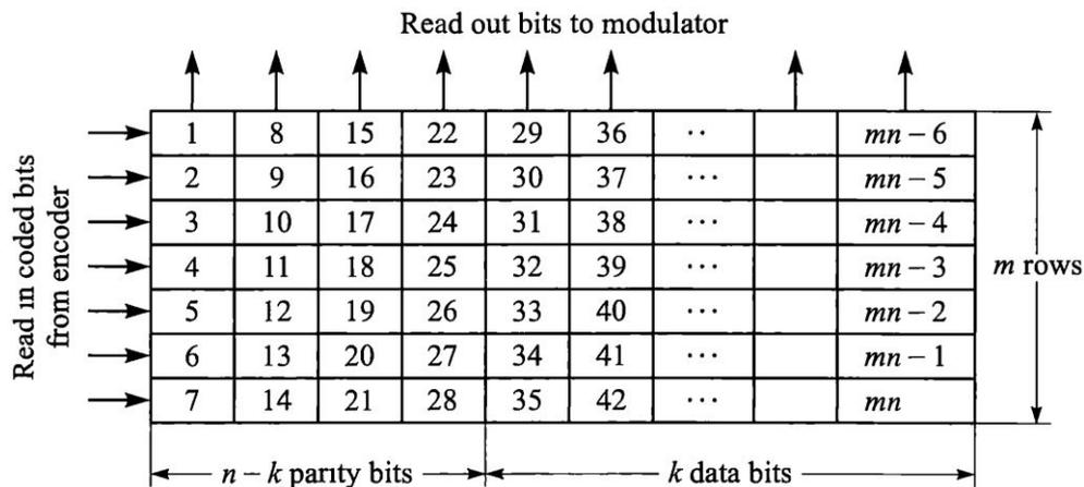
Блочные перемежители записывают поступающие биты по строкам в таблицу размером  $m$  строк на  $n$  столбцов. При этом  $n$  – длина кодового слова,  $m$  – порядок (degree) перемежителя, т.е. число помещающихся в него кодовых слов.
