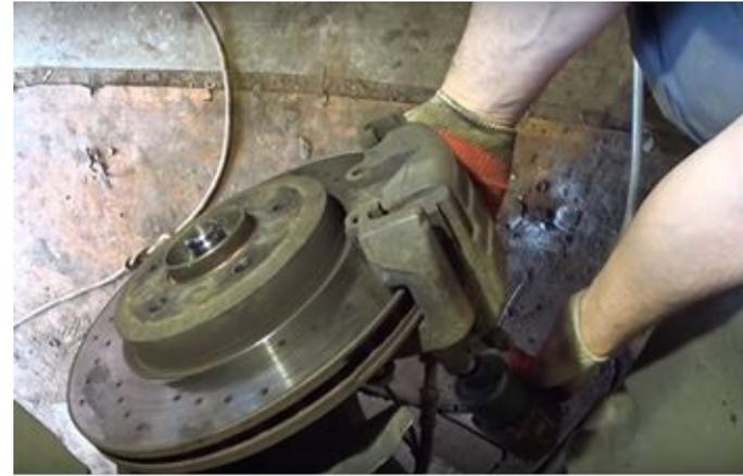
Отворачиваем ступичную гайку, снимаем колеса и отворачиваем суппорт
