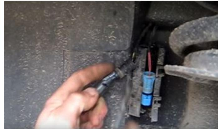
Отсоединяем разъемы АБС и датчика износа колодок
