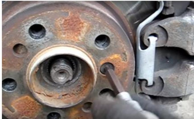
Отворачиваем винт тормозного диска и снимаем его
