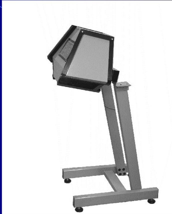
**К** отдельному классу стационарных гамма-нейтронных радиометров можно отнести порталные мониторы для обнаружения радиоактивных загрязнений и источников на транспорте и грузах. В качестве детекторов в них используются органические и неорганические сцинтилляторы больших размеров, также  $\text{He}^3$  и  $\text{BF}_3$  счетчики для нейтронов.
