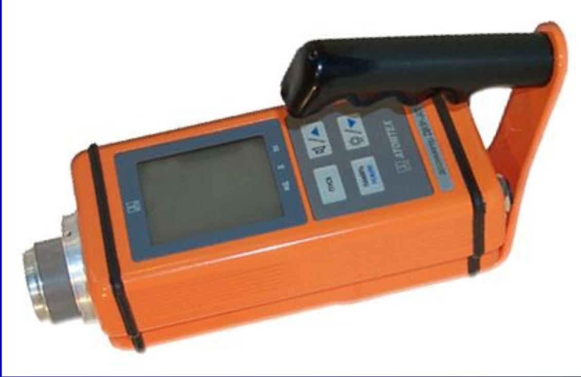
Дозиметры нейтронов измеряют амбиентный эквивалент дозы или ее мощность. В качестве детекторов нейтронных дозиметров используются сцинтилляционные детекторы или He-3 счетчики, окруженные полиэтиленовыми замедлителями и с кадмиевым экраном.
