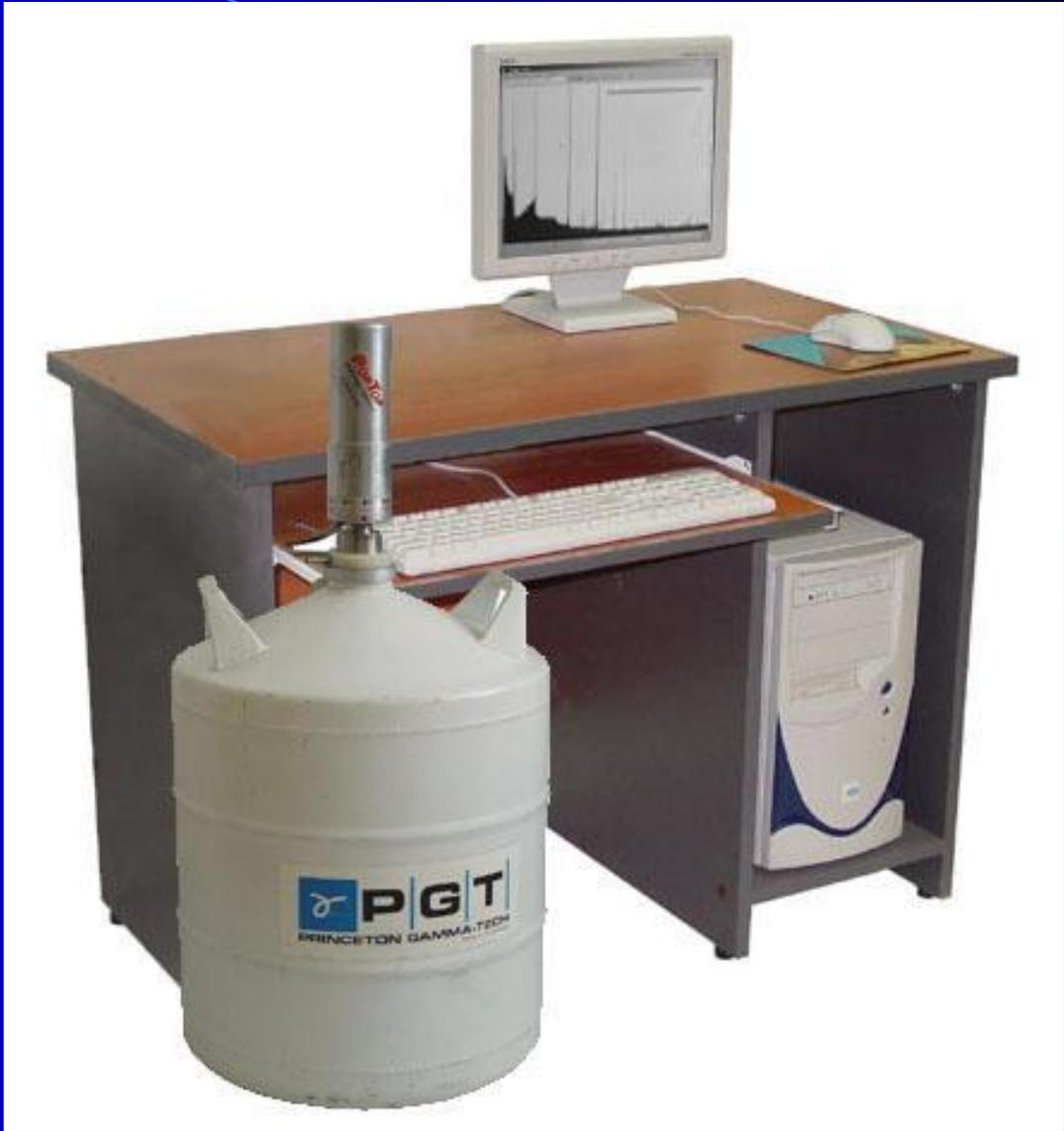
**Сцинтилляционные гамма-спектрометры обеспечивают измерение активностей проб с известным радионуклидным составом (3-4 радионуклида) и используются для рутинных задач радиационного контроля.**
