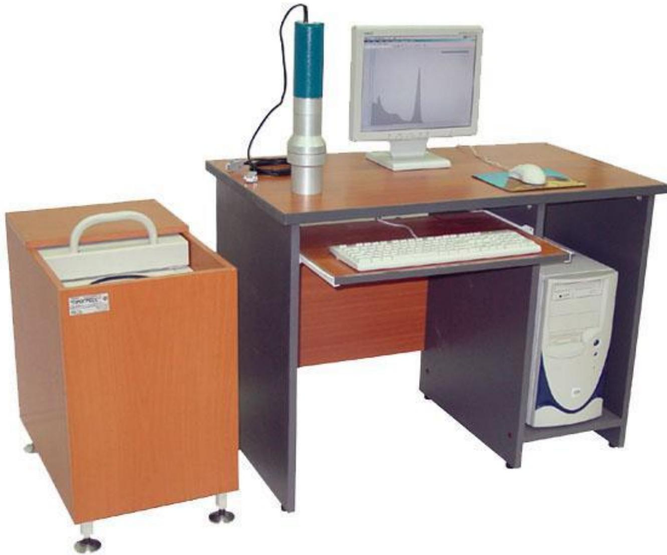
**Радиометры активностей отличаются от спектрометров тем, что активность пробы измеряется после выделения (обычно с помощью радиохимии) конкретного нуклида.**
