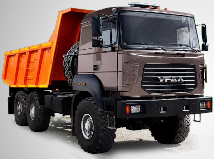
Автомобиль-самосвал с задней разгрузкой предназначен для перевозки навалочных и насыпных грузов, кроме скального грунта, в условиях промышленного и гражданского строительства.
