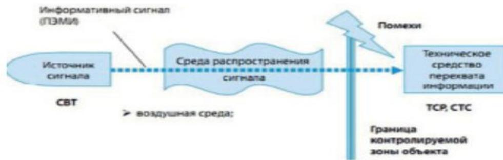
Рис. 1. Схема технического канала утечки информации
