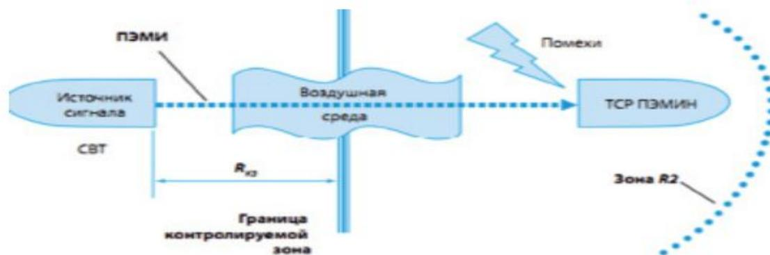
Рис. 2. Схема расположения ТСР ПЭМИН в пределах опасной зоны
