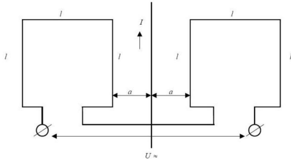
Рис. 4.5. Опыт с индукцией в плоскости Кулона.
