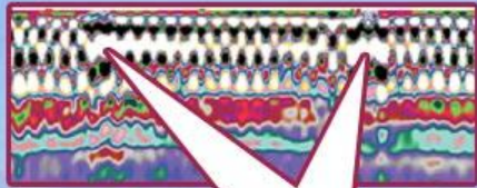
мелкие дефекты в бетоне
