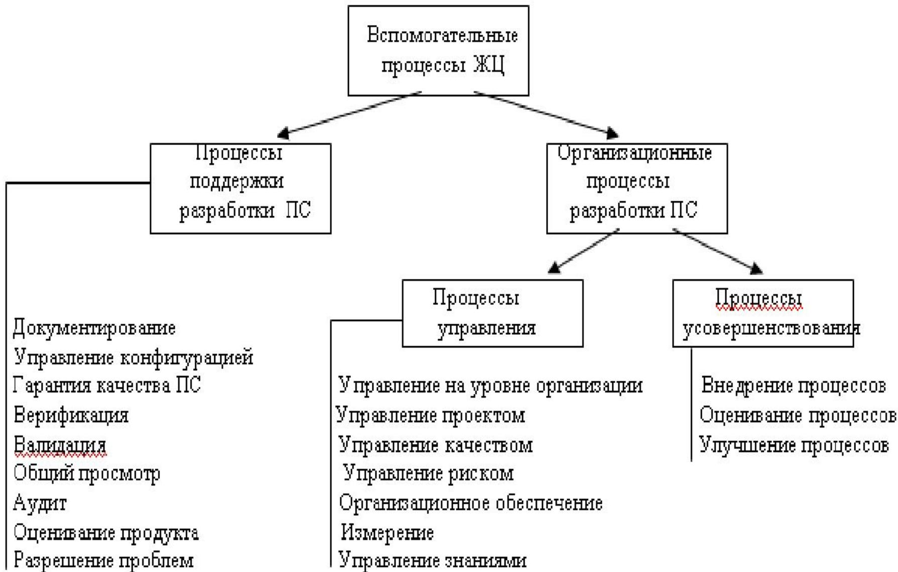
**Рис. 2. Схема вспомогательных процессов ЖЦ ПС**
