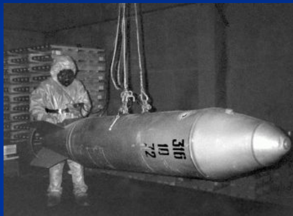
Рис. 7.3. 115-мм реактивный химический снаряд М55 в снаряжении GB или VX: 1 — взрыватель; 2 — корпус с ОВ (головная часть); 3 — корпус реактивного двигателя; 4 — стабилизатор
