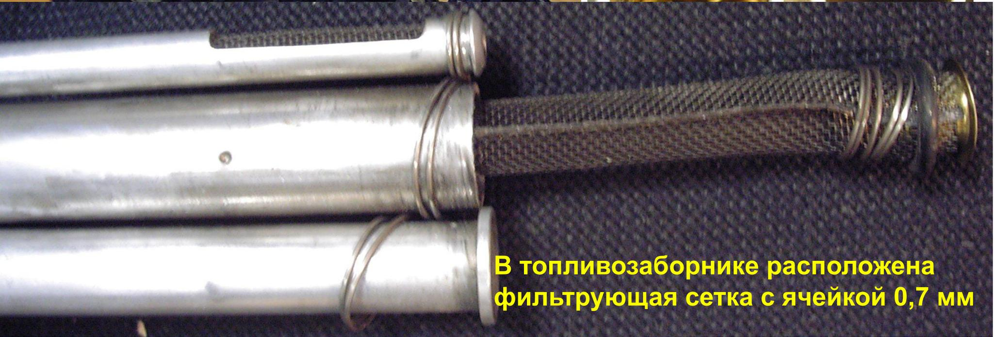
В топливозаборнике расположена фильтрующая сетка с ячейкой 0,7 мм
