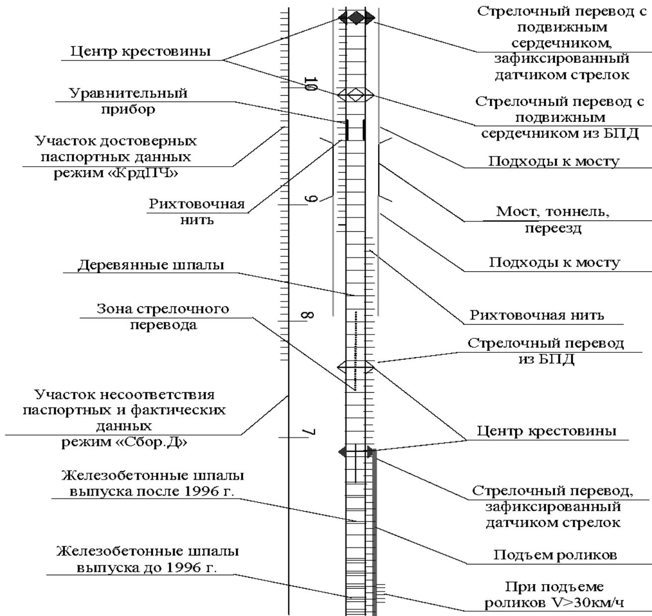
На мониторе располагаются графики параметров состояния пути, на которых можно оперативно посмотреть степень неисправности (зеленый цвет прямоугольника обозначает - 2 степень, желтый - 3 степень и красный - 4 степень), также в заголовке каждой области контролируемого параметра указывается текущее значение
