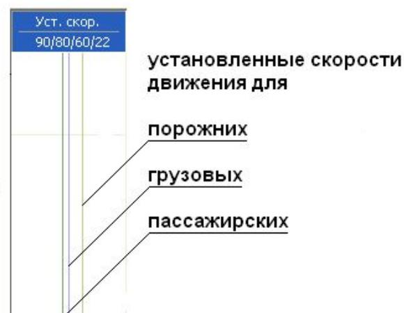
проводится расшифровка под какую скорость, тип стрелочного перевода, вид искусственного сооружения, номера километров и пикетов
