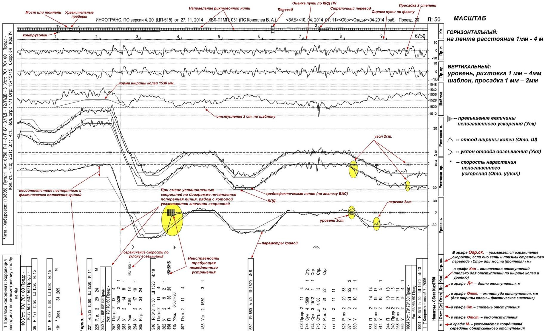
РАСШИФРОВКА ОБОЗНАЧЕНИЙ И ПОКАЗАНИЙ ВАГОНА – ПУТЕИЗМЕРИТЕЛЯ, ОБОРУДОВАННОГО БАС НА ПУТЕИЗМЕРИТЕЛЬНОЙ ЛЕНТЕ
