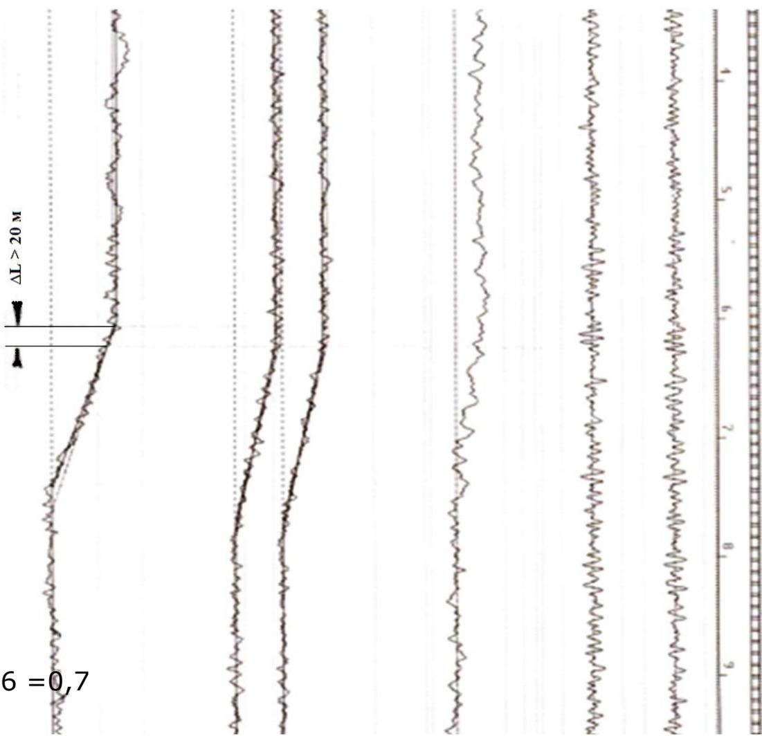
При наличии на километре перечисленных выше несовпадений, требуется уменьшение скорости движения поездов, состояние рельсовой колеи на километре оценивается «неудовлетворительно». При необходимости по диаграмме вагона-путеизмерителя можно рассчитать не только непогашенное ускорение, но и:
