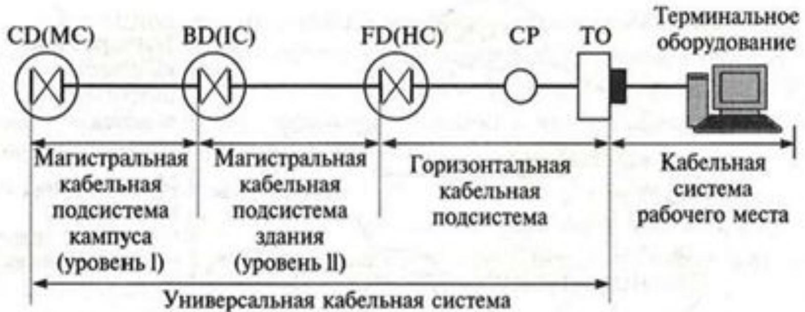
Соединения между подсистемами могут быть или «активными», требующими использования электронного оборудования, поддерживающего работу конкретных телекоммуникационных приложений, или «пассивными». При подключении активного оборудования используются методы кросс- и межсоединения. Пассивные соединения подсистем выполняются на основе кросс-соединений с помощью коммутационных шнуров («патч-кордов») или кроссировочных перемычек
