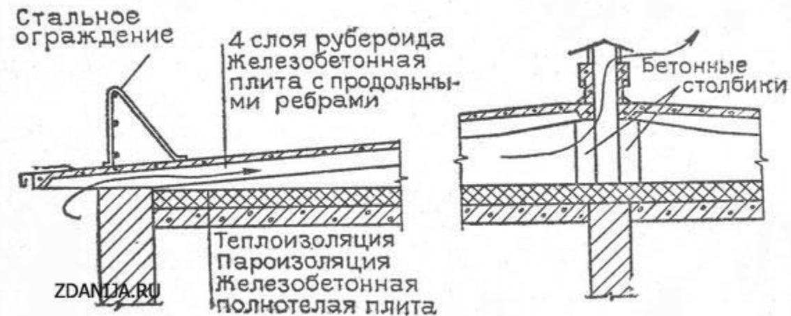
В состав основных элементов совмещенного покрытия входят:
