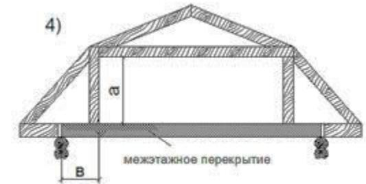
С целью предотвращения подтаивания снега на крыше под влиянием тепла, проникающего снизу через кровлю, образования наледей и сосулек на свесе крыши и повреждения крыш необходимо в соответствии с ранее изложенными требованиями произвести **теплотехнический расчет чердачного перекрытия** и обеспечить его **хорошее утепление**.
