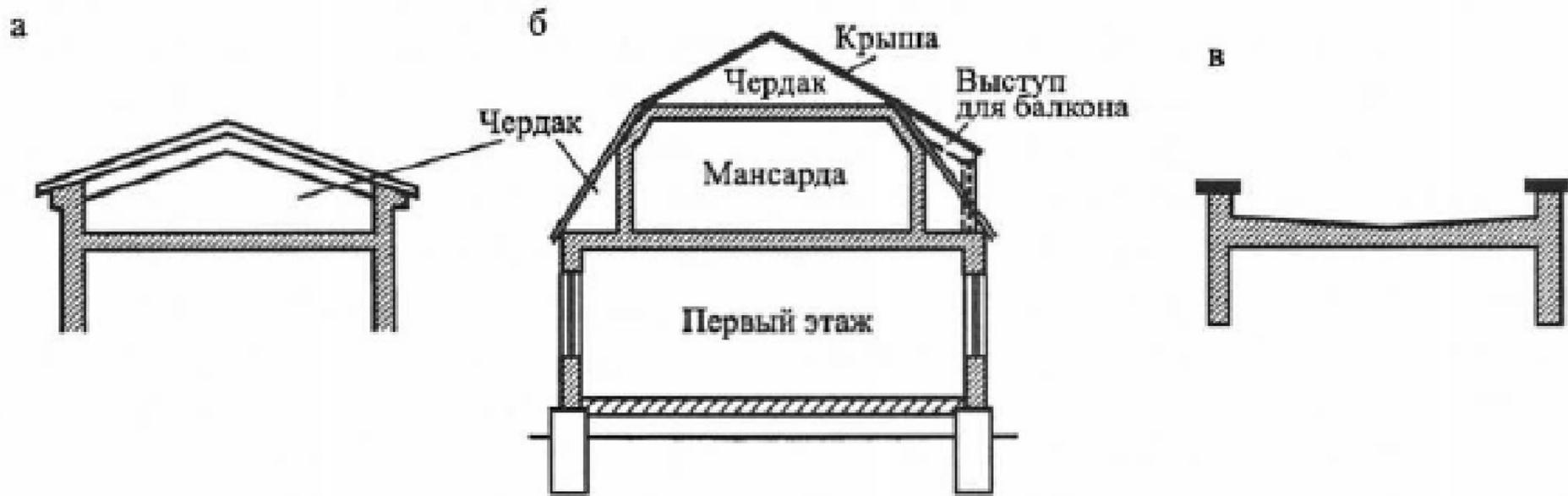
Рис. 20.2. Схемы основных типов крыши: а – чердачная, б – мансардная, в – бесчердачная
