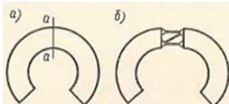
**Контуром** назовем замкнутую линию, образованную осями элементов системы, ограничивающую область, в пределах которой отсутствуют осевые линии, соединяющие точки контура.
