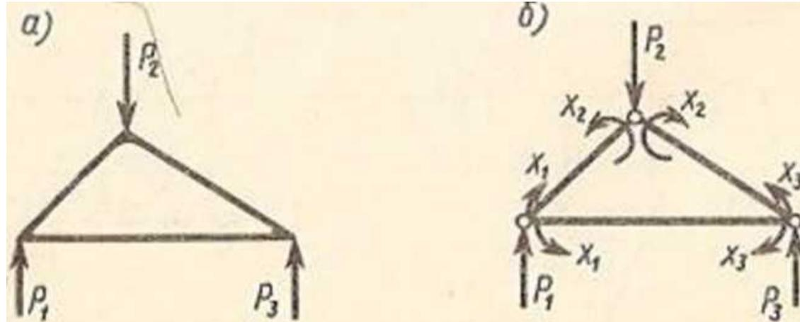
Основная система — шарнирная ферма, поэтому изгибающие моменты в сечениях ее стержней при нагружении внешними силами равны нулю и, следовательно
