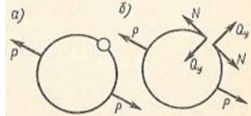
Приведенные сопоставления между числом лишних связей, наложенных на систему, и степенью ее статической неопределимости, можно провести для любой системы. Из этих сопоставлений вытекает, что степень статической неопределимости равна числу лишних связей, наложенных на систему. Однако усилия по некоторым лишним связям могут оказаться известными, поэтому окончательно можно утверждать, что степень статической неопределимости не больше числа лишних связей, наложенных на систему:
