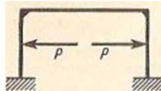
Произвольно выбранный вариант эквивалентной системы, полученный, например, отбрасыванием одной из заделок трижды статически неопределим. Для раскрытия статической неопределимости рамы в этом варианте придется составить и решить систему трех канонических уравнений :
