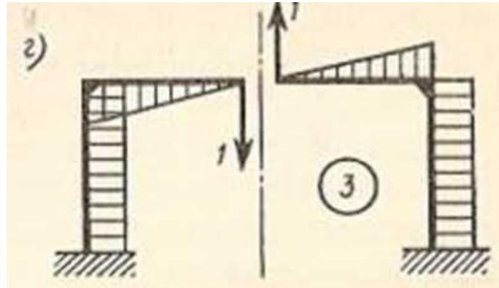
Любое произведение этих эпюр на левой половине системы будет перемещением левой стороны разрезанного сечения, а их произведение на правой половине — перемещением его правой стороны, в одной из схем нагружения основной системы. Следовательно, сумма этих произведений даст относительное перемещение сторон разрезанного сечения в этой схеме нагружения — один из коэффициентов или свободных членов уравнений системы.
