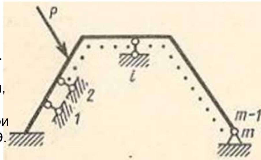
Обозначим:  $\delta_{ip}$  - перемещение сечения, в котором приложено  $X_i$  по его направлению, в основной системе при ее нагружении заданными силами ( $\delta_{ip}$  — перемещение по  $i$ -му направлению в основной системе от заданных сил);  $\delta_{iT}$  - перемещение по  $i$ -му направлению в основной системе от  $T$  (изменения температуры);
