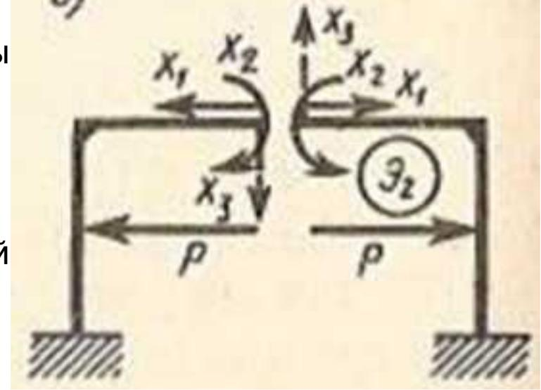
Обратно симметричными назовем силы и эпюры, которые, для того чтобы они стали симметричны, на одной из половин геометрически симметричной системы надо повернуть вокруг ее оси на  $180^\circ$ .
