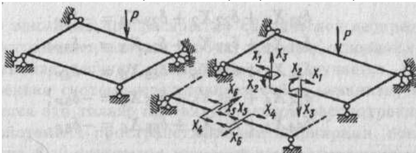
Разрезаем эту раму в произвольном сечении, превращая ее в статически определимую. Обозначим через  $X_1$ ,  $X_2$ ,  $X_3$  силовые факторы, плоскость действия которых перпендикулярна плоскости рамы. Это - изгибающий и крутящий моменты и вертикальная поперечная сила. Остальные три силовых фактора в сечении обозначим через  $X_4$ ,  $X_5$ ,  $X_6$ . На рис. эти силовые факторы, возникающие в плоскости рамы, вынесены для ясности в сторону.
