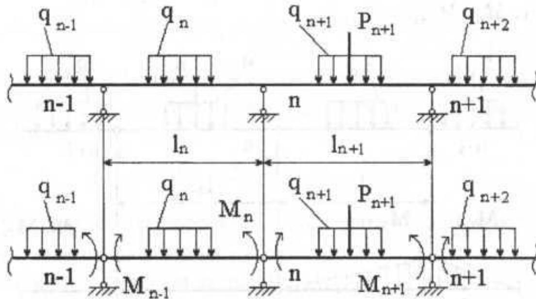
Если крайняя опора представляет собой жесткую заделку, то в заделке добавляется ещё один изгибающий момент и дополнительный пролет, длина которого затем полагается равной нулю.
