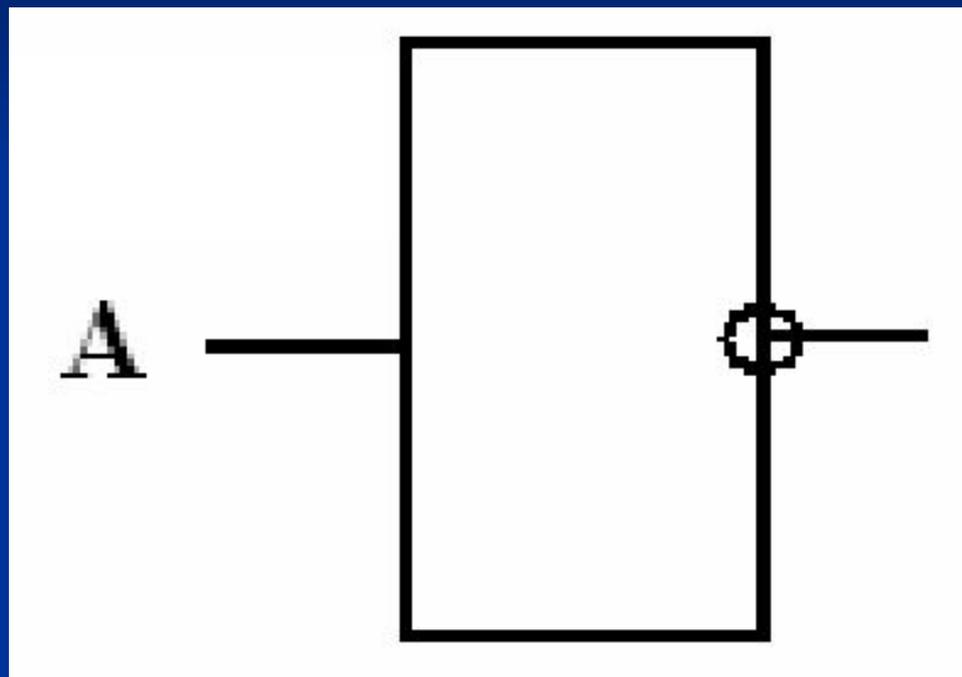
Физически каждый логический элемент представляет собой электронную схему, в которой на вход подаются некоторые сигналы, кодирующие 0 либо 1, а с выхода снимается также сигнал, соответствующий 0 или 1 в зависимости от типа логического элемента.
