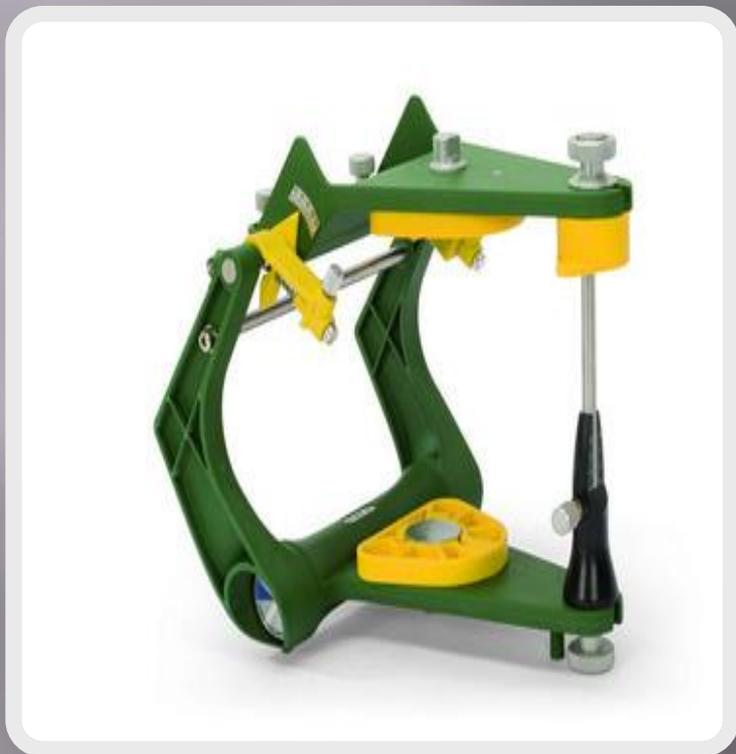
В этом артикуляторе колея для перемещения суставного шарика располагается в нижней, а шарик — в верхней части прибора. Они имеют свободно подвижную ось и движения нижней челюсти в них направляются окклюзионными поверхностями зубов. Такие артикуляторы универсальны, так как могут быть применены для изучения окклюзии и естественных, и искусственных зубных рядов.
