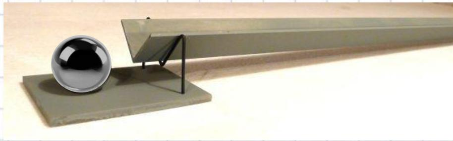
**Цель: определить ускорение движения шарика и его мгновенную скорость перед ударом о цилиндр.**
