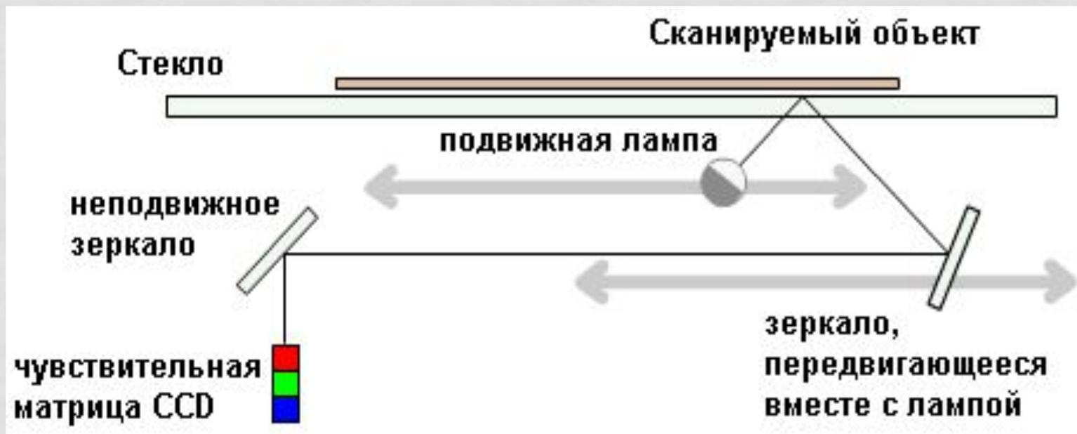
Сканируемый объект кладется на стекло планшета сканируемой поверхностью вниз. Под стеклом располагается подвижная лампа, движение которой регулируется шаговым двигателем.
