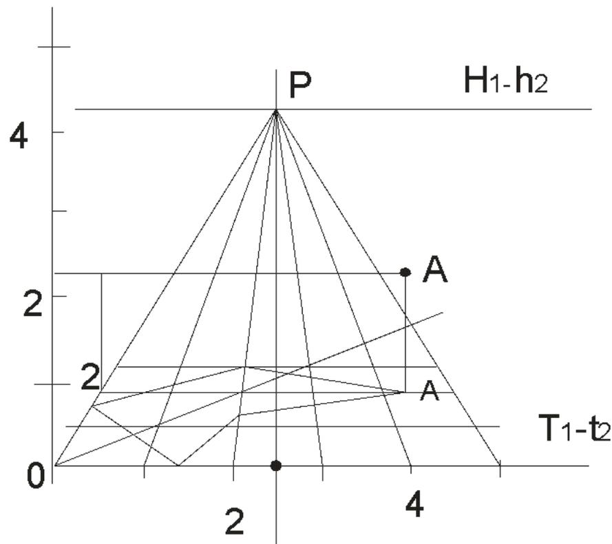
Указать вариант построения падающей тени в перспективе от точки «А» на горизонтальную плоскость проекций при положении солнца за зрителем (сзади):
